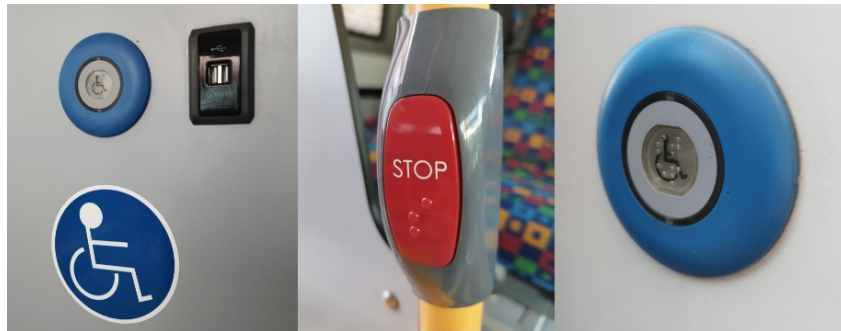
Rys. 14 Oznakowanie elementów autobusów piktogramami i znakami w języku Braille’a
